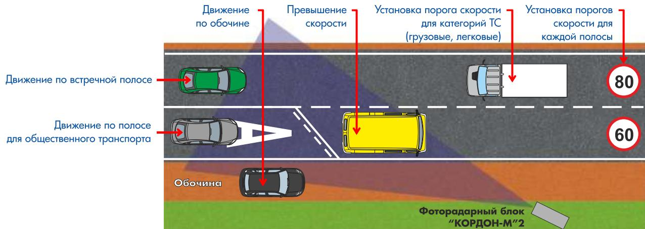
Данные о нарушении включают в себя также распознанный номер, зафиксированную скорость ТС, тип нарушения, направление движения, дату и время нарушения, значение максимально допустимой скорости на данном участке дороги, название контролируемого участка, географические координаты, серийный номер комплекса.
